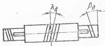
Рис. 40. Передача, заменяющая червячную
