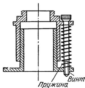
Рис. 35. Фокусирующее устройство с винтом
