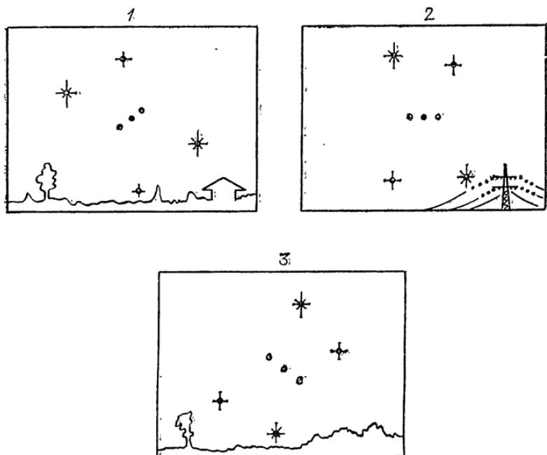
Рис. 46. Вращение поля зрения при фотографировании астрографом на азимутальной монтировке
