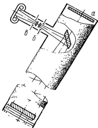
Рис. 86. Солнечный телескоп Рувьера: отражающий фильтр (а), диафрагма в плоскости изображения (б), диафрагма в плоскости выходного зрчка (в)
