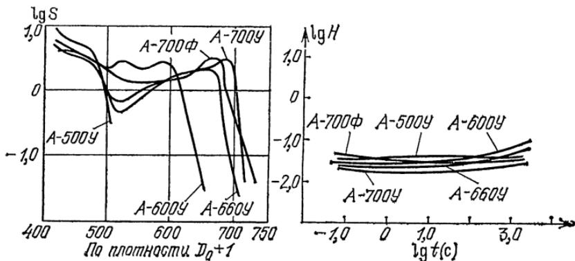
Рис. 20. Кривые спектральной чувствительности и изопаки астрономических пленок А-500У, А-600У, А-700У, А-700Ф
