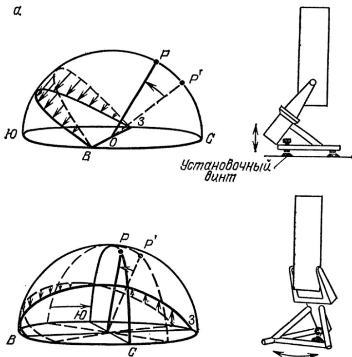
Рис. 53. Положение инструментального полюса, экватора и меридиана при неправильном угле наклона полярной оси (а) и неправильном азимуте оси (б)
