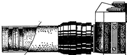
Рис. 34. Фотоаппарат с фокусирующим устройством
