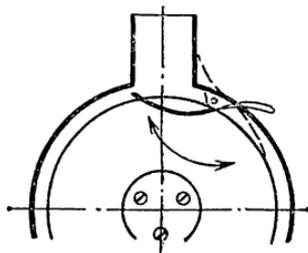
Рис. 31. Затвор в телескопе системы Ньютона
