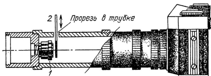
Рис. 24. Окулярная камера: 1 — проекционный объектив или окуляр, 2 — затвор-заслонка
