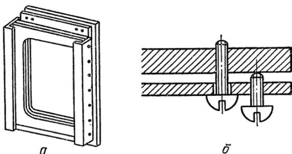
Рис. 28. Кассетная часть астрографа (а) и юстировочные винты (б)
