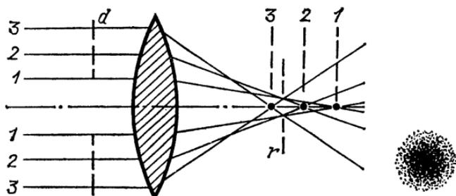
Рис. 10. Сферическая aberrация,  $r$  — кружок наименьшего рассеяния. Справа — вид пятна в фокальной плоскости
