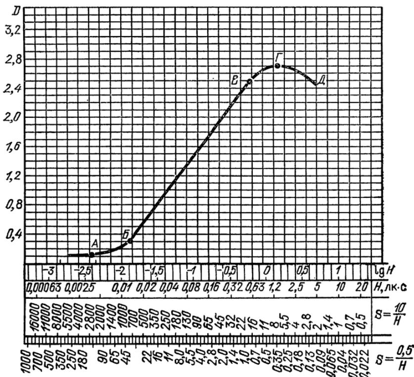
Рис. 18. Характеристическая кривая, построенная на сепситометрическом бланке
