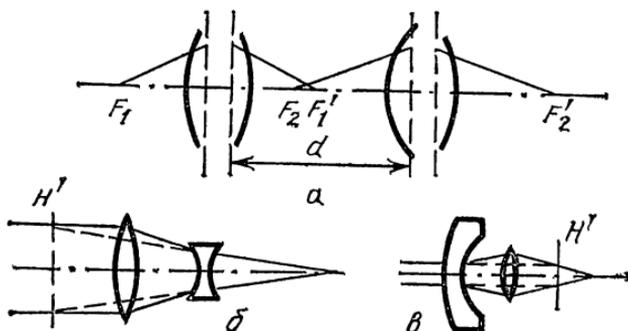
Рис. 7. Система из двух линз: определение фокусного расстояния (а), телеобъектив с сильно вынесенной главной плоскостью (б), широкоугольный объектив с удлиненным вершинным фокусным расстоянием (в)
