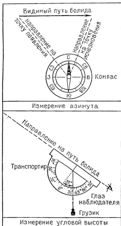
Рис. 48. Определение азимуты и угловых высот точек начала и конца траектории болида
