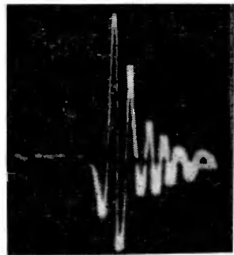
Рис. 12. Импульсный сигнал дельфина для серии с малой частотой следования.
