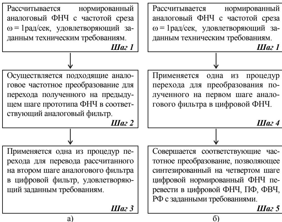
Рис. 6.1. Общие процедуры расчета цифровых многопроцессорных фильтров
