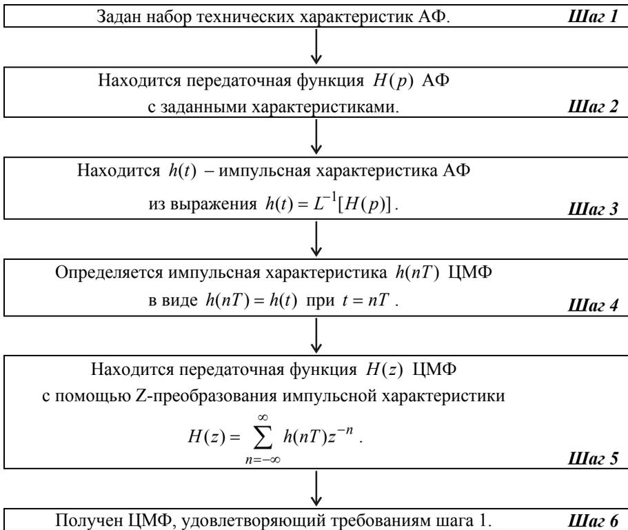
Рис. 6.9. Процедура расчета по методу инвариантности импульсной характеристики
