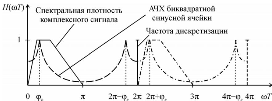
Рис. 4.33. Пример расположения дискретизированного спектра комплексного (аналитического) сигнала и АЧХ биквадратной синусной ячейки
