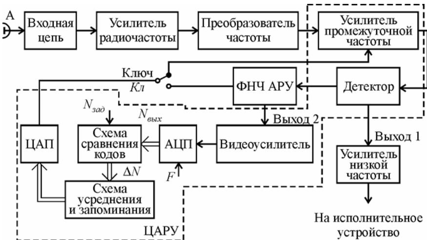
Рис. 14.1. Структурная схема РПрУ с ЦАРУ и аналоговой АРУ
