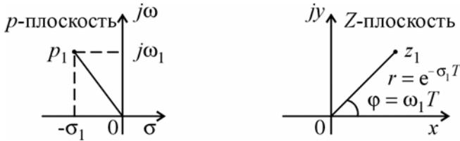
Рис. 3.1. Преобразование точки из  $p$ -плоскости в  $Z$ -плоскость
