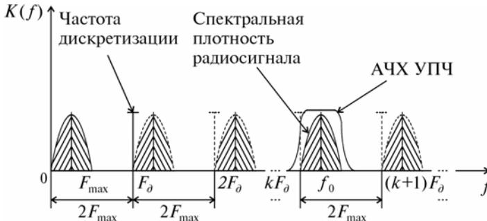
Рис. 2.3. Виды спектральной плотности сигнала при выборе частоты дискретизации  $F_\delta \geq 2F_{\max}$
