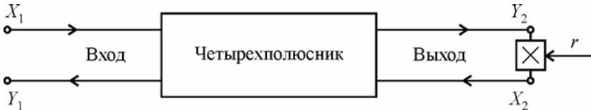
Рис. 9.4. Структурная схема четырехполюсника с включенным перемножителем
