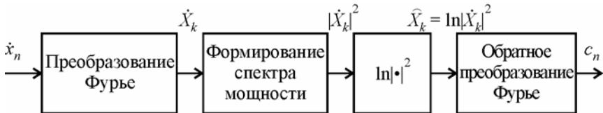
Рис. 12.6. Структурная схема системы вычисления кепстра
