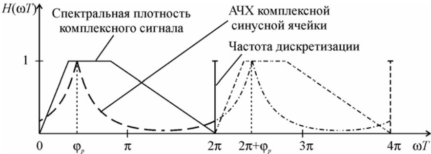
Рис. 4.32. Пример расположения дискретизированного спектра комплексного (аналитического) сигнала и АЧХ цифровой комплексной синусоидальной ячейки
