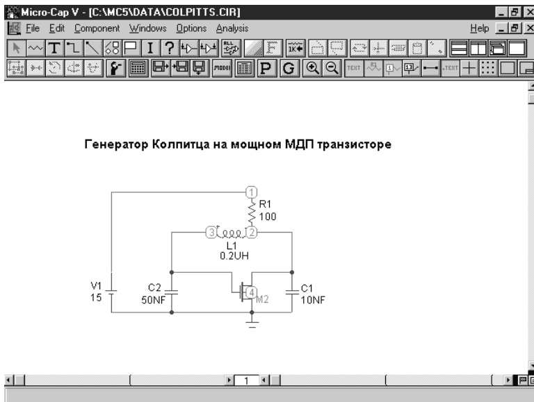
Рис. 11.14. Схема генератора Колпитца на мощном полевом транзисторе
