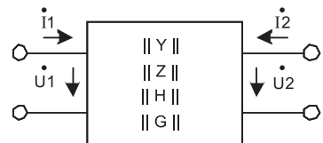
Рис. 9.2. Обобщенная схема усилителя мощности на активном четырехполюснике
