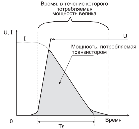
Рис. 2.33. Мощность, потребляемая МДП-транзистором при выключении
