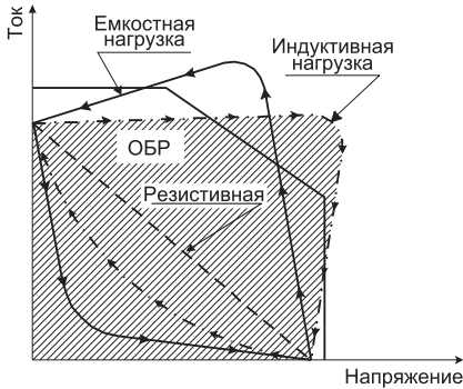
Рис. 2.32. ОБР и траектории движения рабочей точки при различных видах нагрузки МДП-транзистора
