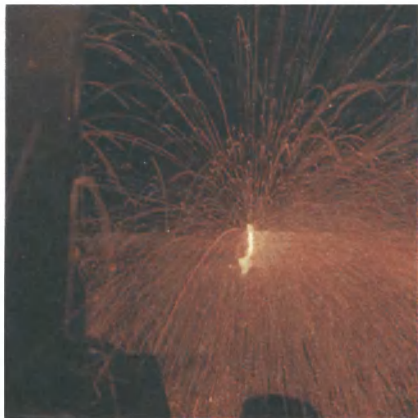
Процесс контактной стыковой сварки оплавлением.
