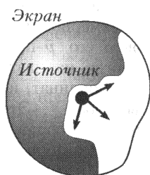
Рис.2. Приспособление, позволяющее увидеть, по каким направлениям вылетают частицы из точечного источника
