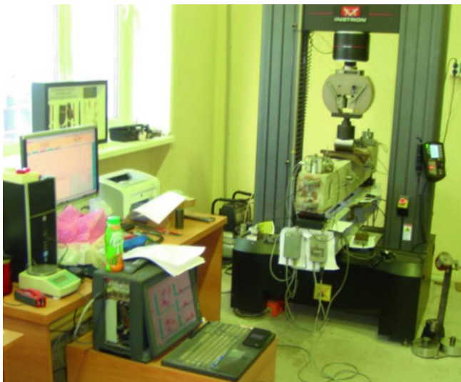
Рис. 1. Нагружающее устройство INSTRON 8802 с установленной балкой Fig. 1. INSTRON 8802 loading device with a beam installed
