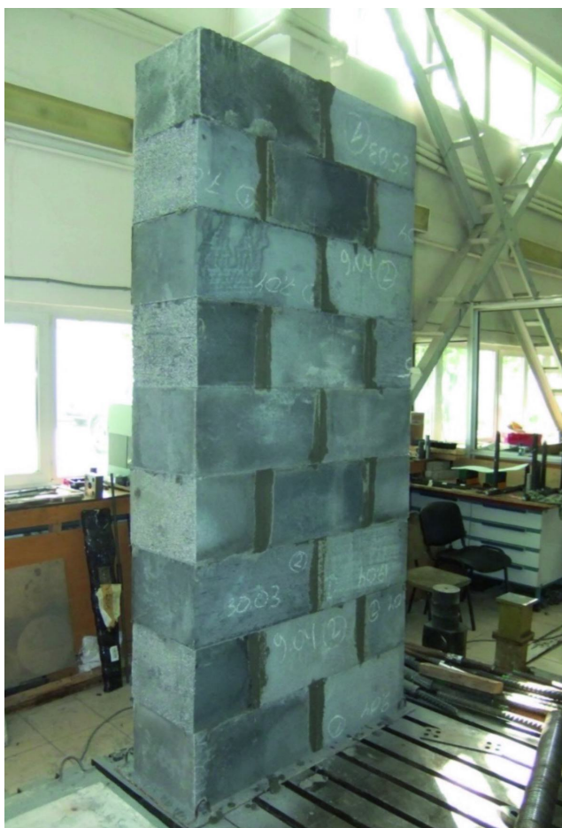
Рис. 1. Фрагмент стены перед испытанием на ветровую нагрузку Fig. 1. Fragment of the wall before testing on wind load
