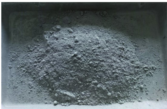
Рис. 2. Общий вид рециркуляционного тонкодисперсного бетонного порошка Fig. 2. General view of recycling fine concrete powder
