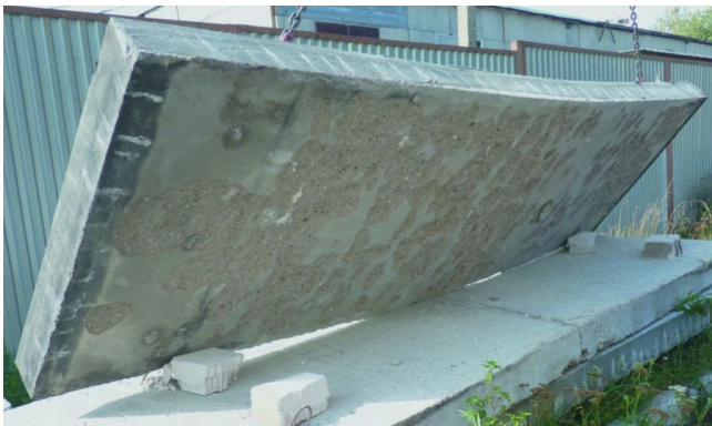
Рис. 5. Вид обогреваемой поверхности плиты серии 2 (9 % микрокремнезема в ВБ) после огневого испытания. Класс бетона – В60
