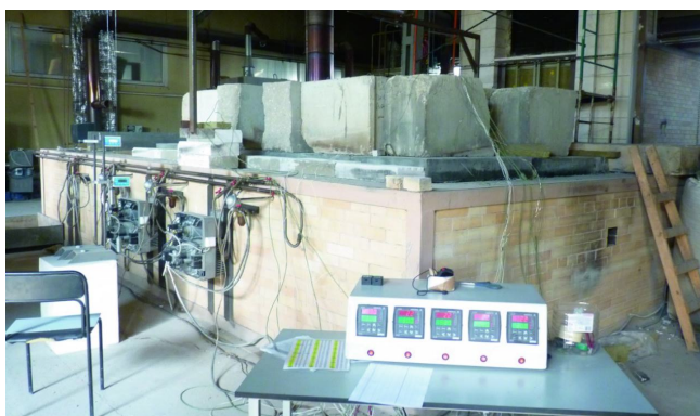
Рис. 3. Характерный вид плит серии 6 под нагрузкой перед огневым испытанием Fig. 3. Characteristic view of the series 6 plates under load before the fire test
