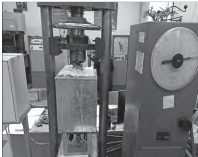
Рис. 2. Вид установки для испытаний бетонного образца-призмы на осевое сжатие с построением диаграммы деформирования « \sigma – \varepsilon » при нагреве
