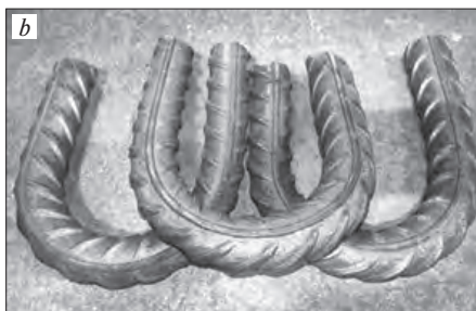
Рис. 2. Образцы после испытаний: а – при растяжении; б – при изгибе Fig. 2. Samples after testing: a – tensile testing; b – bending
