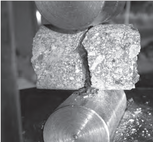
Рис. 1. Пример испытанного образца на растяжение при раскалывании по предлагаемой схеме двухточечного приложения нагрузки Fig. 1. Example of a split tensile test specimen using the proposed two-point load application scheme
