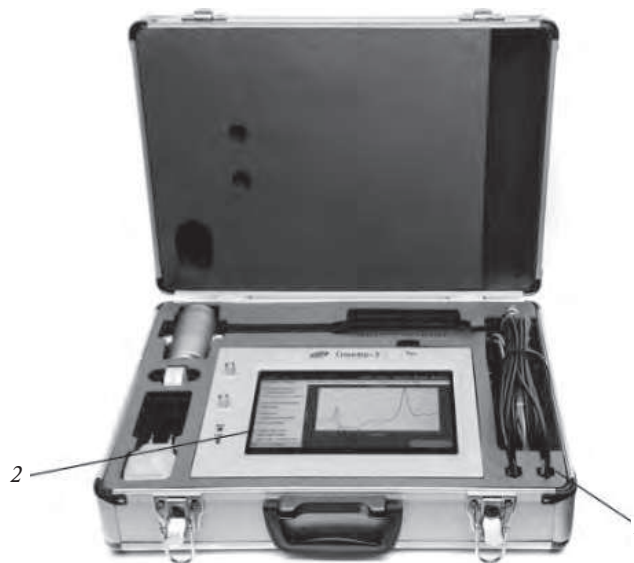
Рис. 7. Общий вид прибора «Спектр-3.0»: 1 – сейсмоприемник; 2 – устройство для записи, обработки и отображения данных Fig. 7. The «Spektr-3.0» device: 1 – geophone; 2 – device for recording, processing and displaying data
