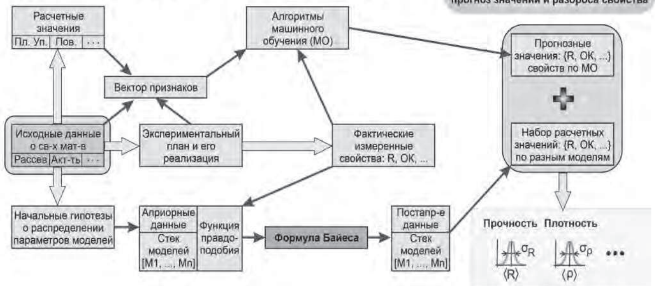
Рис. 5. Схема построения вероятностной модели и алгоритм ее реализации Fig. 5. Scheme for constructing a probabilistic model and an algorithm for its implementation
