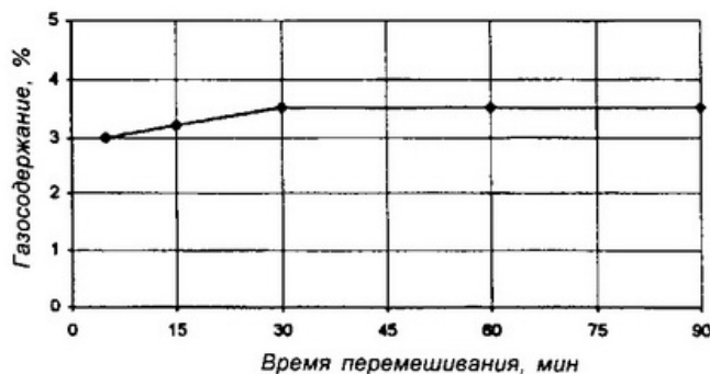
Рис. 9. Влияние длительности перемешивания бетонной смеси с МБ 10-01 (10% массы Ц+МБ) и добавкой 136-41 на ее газосодержание (расход цемента 490 \text{ кг/м}^3 )
