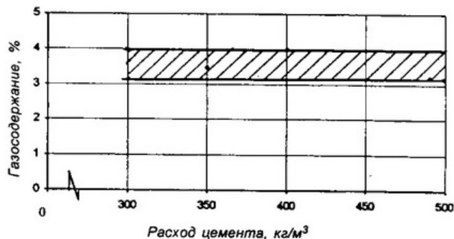
Рис. 7. Зависимость газосодержания бетонных смесей с добавками МБ 10-01 (10% массы Ц+МБ) и КОЖ 136-41 от расхода цемента
