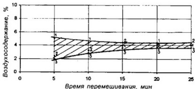
Рис. 6. Изменение воздухосодержания бетонных смесей с добавкой СНВ и модификатором бетона МБ 10-01 в количестве 10% массы цемента во времени в процессе их перемешивания в автобетоносмесителе
