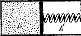
Рис. 1.28. Когда поршень смещается на некоторое макроскопическое расстояние, пружина A' совершает работу над газом A .
