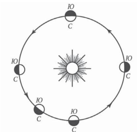
Рис. 16. Как двигался бы земной шар вокруг Солнца, если бы ось вращения Земли лежала в плоскости ее орбиты
