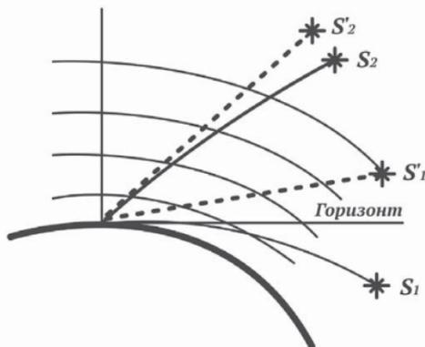
Рис. 15. Атмосферная рефракция. Луч, исходящий от светила  $S_2$ , проходя земную атмосферу, преломляется в каждом ее слое и искривляется, вследствие чего наблюдателю луч кажется вышедшим из точки  $S'_2$ , лежащей выше. Светило  $S_1$  уже зашло за горизонт, но благодаря рефракции наблюдатель еще видит его
