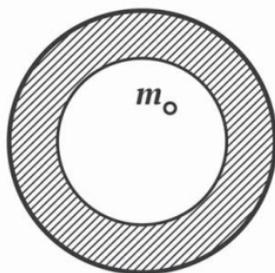
Рис. 91. Тело внутри шаровой оболочки не имеет веса
