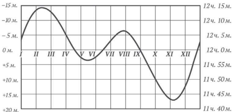
Рис. 7. Этот график, именуемый «графиком уравнения времени», показывает, как велико в тот или иной день расхождение между истинным и средним полуднем (левая шкала). Например, 1 апреля в истинный полдень верные механические часы должны показать 12 ч. 5 м.; иными словами, кривая дает среднее время в истинный полдень (правая шкала)
