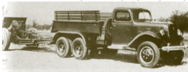
3-тонный Marmon-Herrington C5-6 (1937) на испытаниях в качестве артиллерийского тягача
