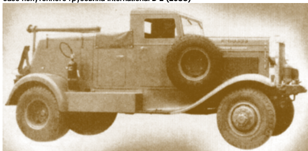
Marmon-Herrington C90-BWS-4 (1938) — автомобиль с лебёдкой для запуска аэро-статов, строившийся для Воздушного корпуса армии США
