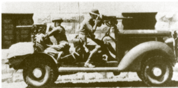
Пулемётный автомобиль, созданный на базе Marmon-Herrington OT2-4 в 1939 г. Эта машина применялись в армии США в учебных целях
