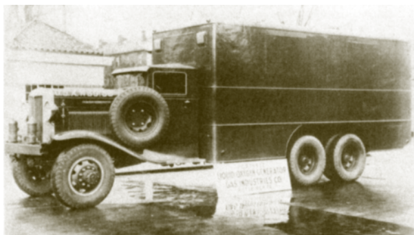
Marmon-Herrington TH315-6 Воздушного корпуса армии США (1933). В фургоне размещена установка для получения жидкого кислорода
