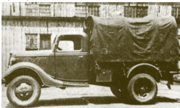
Marmon-Herrington B5-4x4 (1935) — первый полноприводный автомобиль компании, созданный на базе грузовика Ford
