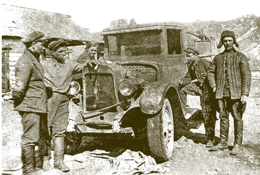
Бензозаправщик типа «БЗ» на шасси ЗИС-6. Надпись на дверце: «СовМонгТувТорг». Чуйский тракт, 1936 г.
