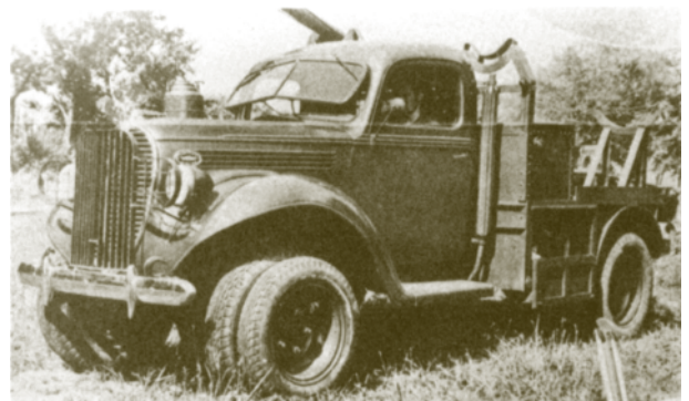
Буровая установка для строительства телефонных линий на шасси Marmon-Herrington E5-4 (1938). Эти машины применялись в подразделениях связи армии США
