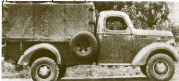
Автомобиль Marmon-Herrington типа 4x4 для Береговой охраны США, созданный на базе полутонного грузовика International D-2 (1938)
