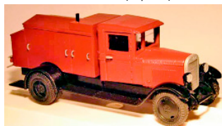
Компрессорная станция ЛГПО на шасси ЗИС-5 (Сергеев)
