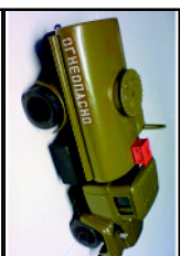
ЗИЛ-130. Цистерна. Кабина — металл, кузов — пластмасса, колеса — эпоксидная смола/резина. Цвет: кабина — голубой, защитный, цистерна — оранжевая, защитная. ДПК #4306/4306р
