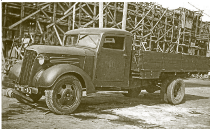
Пресловутая фотография «лже-ЯГ-7» из книги по истории ЯАЗ—ЯМЗ 1966 г. На самом деле — 2-тонный Chevrolet японской сборки (вверху)
