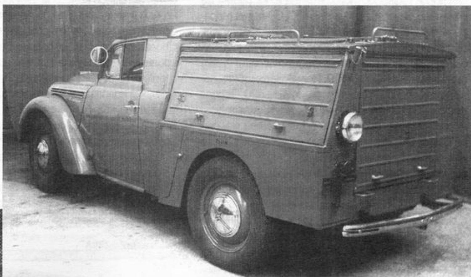
Москвич-401-420, аэродромная пусковая установка
