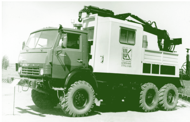
Фото 28. Агрегат ЗАОК (АРК-СК) на шасси КамАЗ-43101 последнего выпуска: новый бумер и кронштейны зеркал заднего вида. ЗАО «Озониг-Лукойл» (г. Октябрьский)
