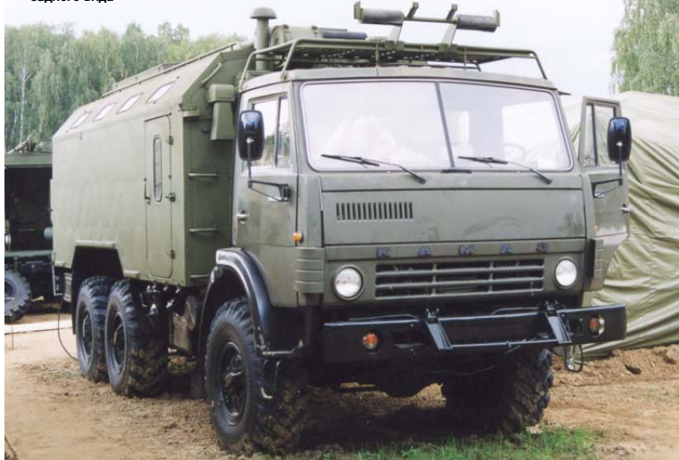
Фото 27. Мастерская МРС-АМ на шасси КамАЗ-43101 последних выпусков: новые кронштейны зеркал заднего вида
