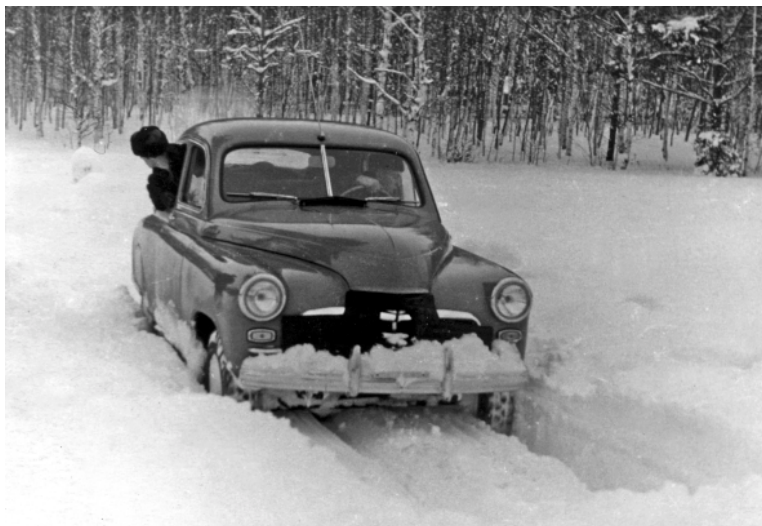
Движение по мягкому снежному покрову глубиной до 50 см
