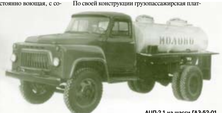
АЦП-2,1 на шасси ГАЗ-52-01
