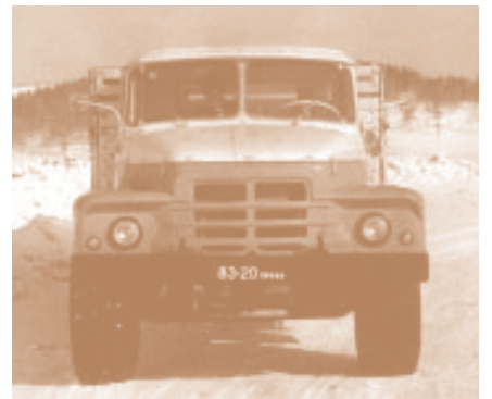
Урал-377М с пластиковым оперением. 1968 г.
