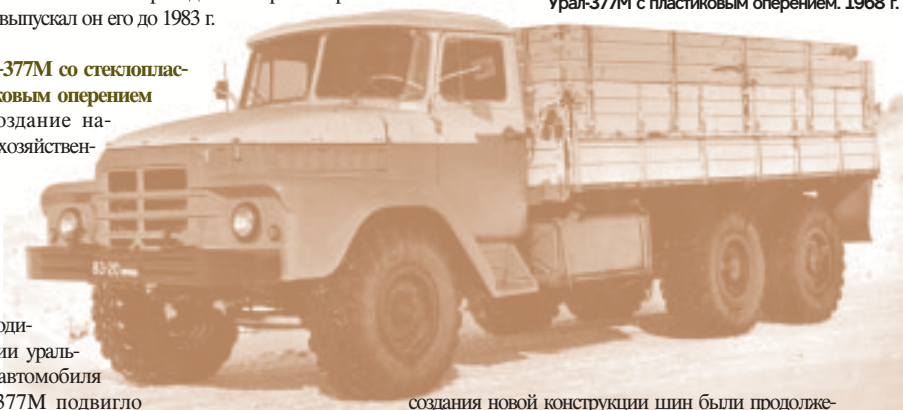
Урал-377М с пластиковым оперением. 1968 г.
