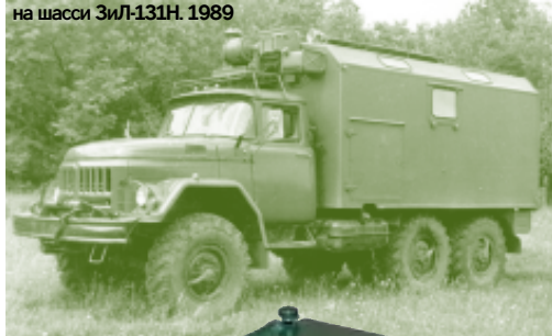
Автомобильная мастерская МС-А модели 49141 на шасси ЗиЛ-131Н. 1989
