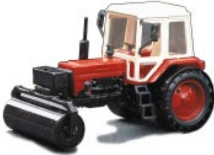
Дорожный каток на базе трактора МТЗ-80 (VOLGA, конверсия)
