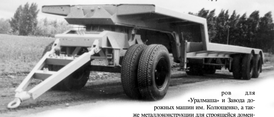
Полуприцеп-тяжеловоз ЧМЗАП-93853 с подкатной тележкой ЧМЗАП-8379
