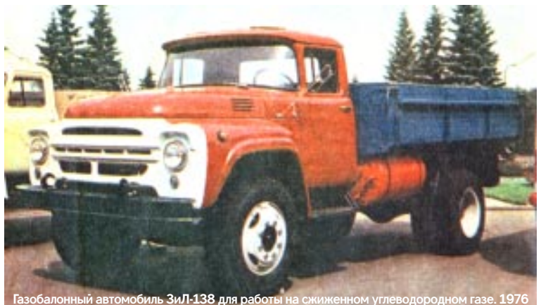
Газобаллонный автомобиль ЗиЛ-138 для работы на сжиженном углеводородном газе. 1976
