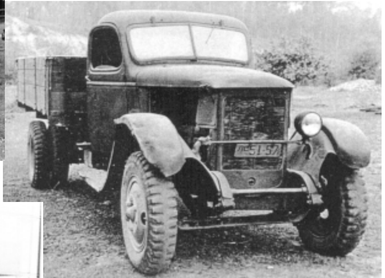
Зис-5 с кабиной и капотом от Chevrolet G7107. Фото из архива Л. Сусливичюса
