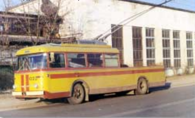
Грузовой троллейбус Škoda Š 9TR. Переделка из ранних троллейбусов. Ул. Ганибу Дамбис. Рига. Фото автора
