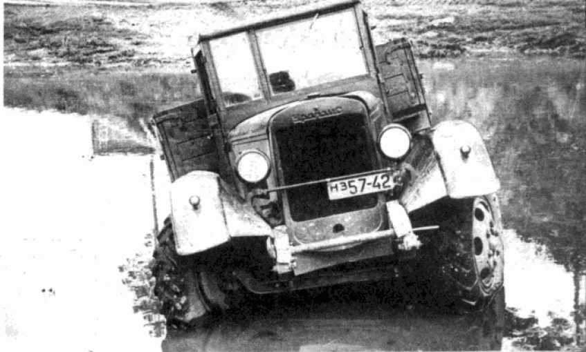
На Урал-ЗИС-355 помимо шин М-63 «Универсал» применяли и шины «Вездеход», которые значительно повысили проходимость автомобиля
