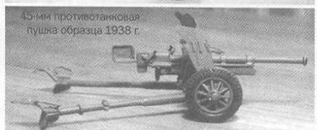
45-мм противотанковая пушка образца 1938 г.
