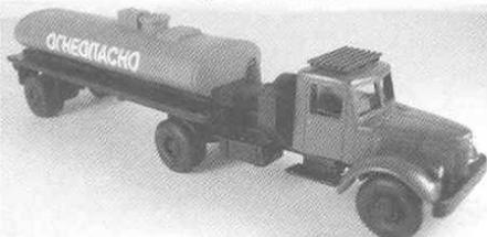
МАЗ-200В с полуприцепом-цистерной
