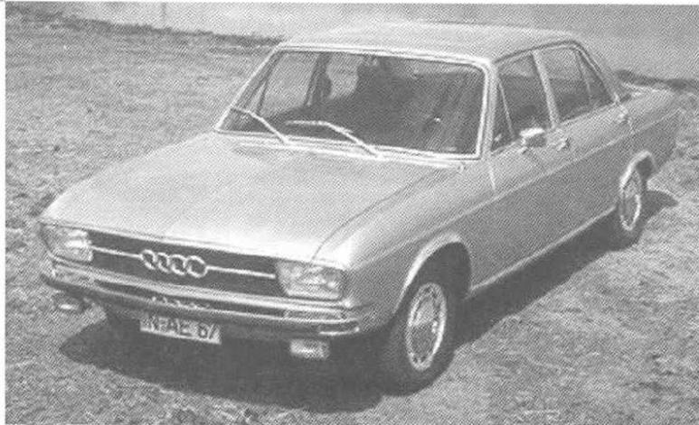
«американская» версия развивала мощность 75 л.с. при 5600 об/мин и крутящий момент 12,2 кгс·м при 3200 об/мин. С 1978 г. Audi 100 начали оборудовать дизельными двигателями. В конце 1979 г. была выпущена топ-версия модели «100» – Audi 200, отличавшаяся высоким уровнем базовой комплектации и мощными пятицилиндровыми моторами.
