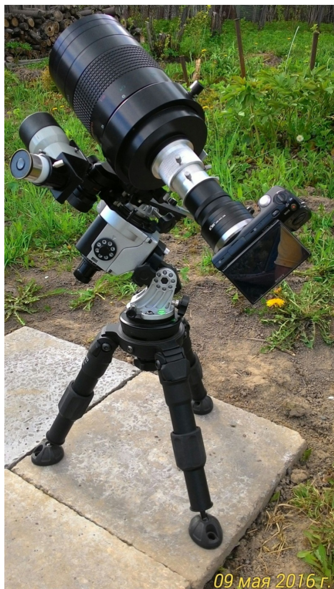
Рис. 7. Телескоп на базе объектива МС Рубинар-10/1000 (конфигурация для съемки в окулярной проекции)
