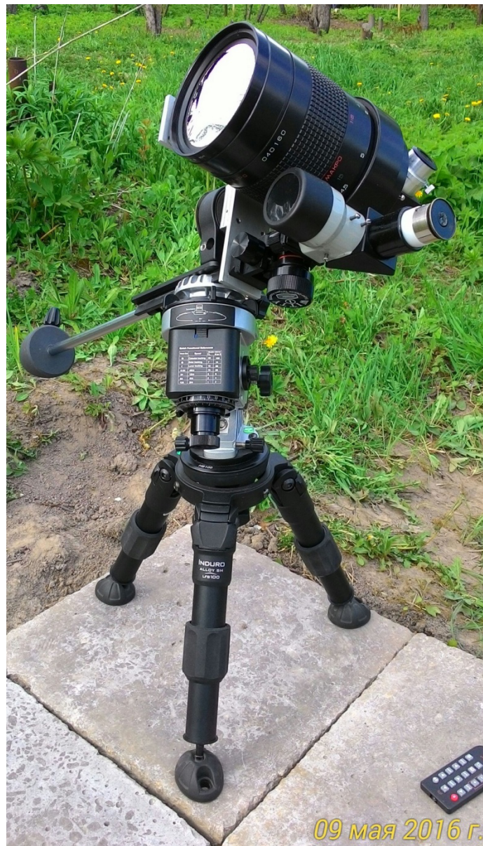
Рис. 8. Телескоп на базе объектива МС Рубинар-10/1000 (конфигурация для визуальных наблюдений)
